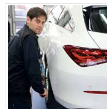
14.32 Uhr: Nachziehen der Radmutter mit einem Drehmomentschlüssel nach der Probefahrt.
